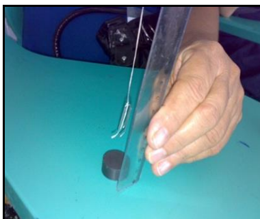
Figura 8 - medindo a distância da força de atração magnética
