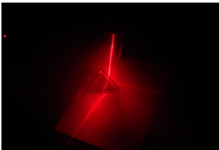
Figura 10: Desvio na trajetória do raio ao atravessar um prisma.
