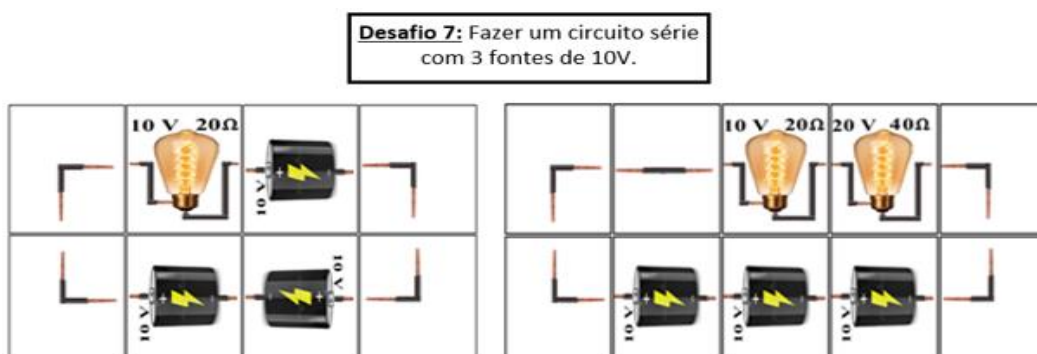
Figura 6: Possíveis circuitos completos do Desafio 7
