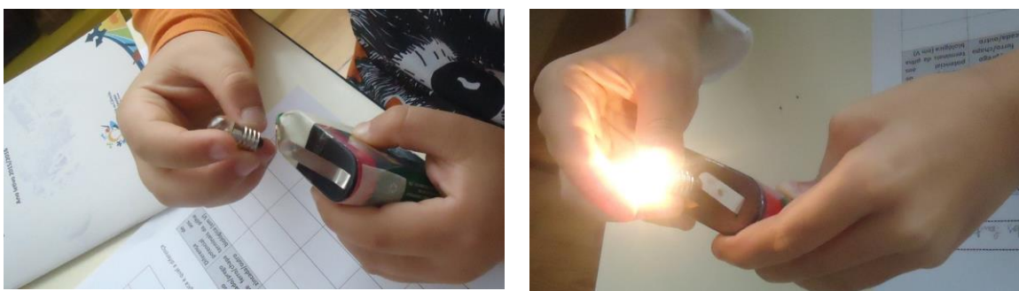
Figura 3: Acender uma lâmpada com uma pilha. Fonte: Observação da aula (fotos da primeira autora).
