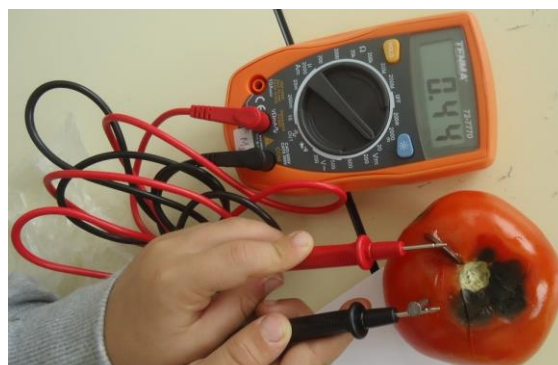
Figura 6: Circuitos com pilhas biológicas e medição da diferença de potencial de pilhas biológicas. Fonte: Observação presencial (fotos da primeira autora).
