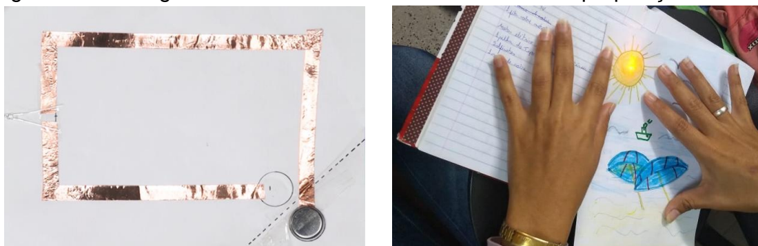
Figura 2 – Montagem do circuito desenvolvido e efeito da superposição do LED.
