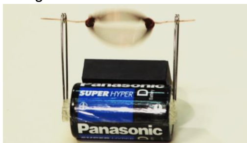
Figura 3 – Montagem do motor elétrico de corrente contínua.
